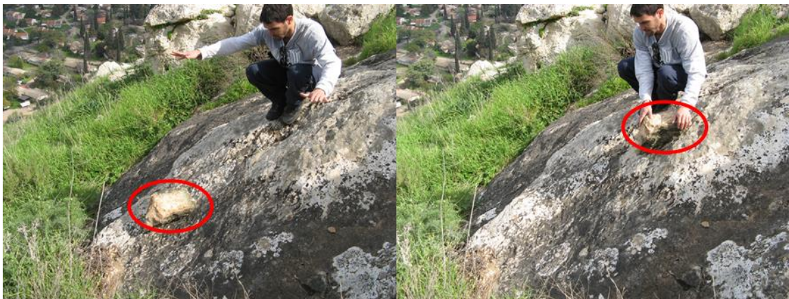
איור 13. ניסוי שדה למדידת זווית החיכוך הפנימי. הסלע המחליק מוקף בעיגול אדום.
