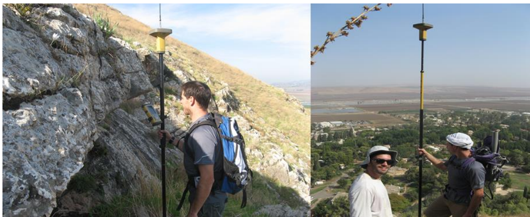
איור 24. תצלומים שונים המציגים את המדידות בעזרת מכשיר ה-GPS-RTK במורד המדרון.
